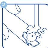
**2 Rincer l'extrémité de la sonde de pH sous l'eau du robinet fraîche.** Ne jamais utiliser d'eau osmosée (obtenue par osmose inverse), distillée ou désionisée.
