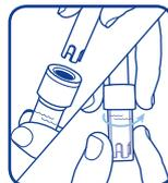
S'assurer que l'extrémité de la sonde est recouverte par la solution de conservation KCl dans le capuchon.
