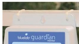
Colliers de serrage passés dans les petits orifices de fixation et enroulés autour d'un support ou d'une lisse.
