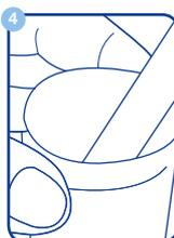
**4 Remuer doucement l'extrémité de la sonde dans ce mélange.** Veiller à ne pas cogner la sonde de pH pour sols contre la paroi du récipient, sous peine d'endommager la sonde.
