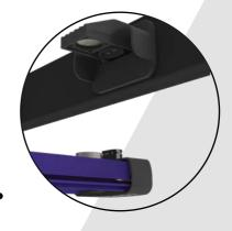
Insérez ensuite l'autre extrémité; alignez le connecteur magnétique de la barre lumineuse avec le trou rond du connecteur du cadre et insérez la broche mâle dans la prise femelle. Assurez-vous que la connexion magnétique est bien fixée.
