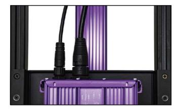
Pour connecter la sortie du transformateur et du contrôleur de variation à l'appareil, assurez-vous que les connecteurs mâles autobloquants d'alimentation et de variation sont correctement alignés avec les connecteurs femelles correspondants du transformateur et poussez-les ensemble jusqu'à ce qu'ils soient verrouillés par un clic.
